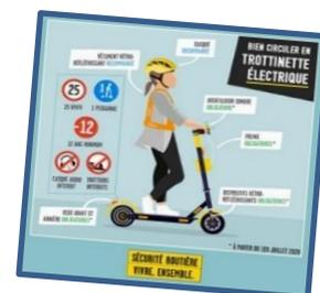
Rappel : Depuis le 1er juillet 2020, les EDP doivent également être équipés de feux avant et arrière, de dispositifs rétro-réfléchissants, de freins et d'un avertisseur sonore.
